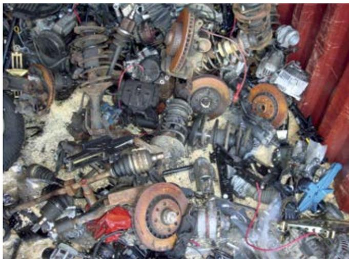
Autoteile gelten als Abfall, wenn sie Flüssigkeiten verlieren. Flüssigkeiten enthaltende Fahrzeugteile sollten deshalb nicht als Schüttgut transportiert werden.
