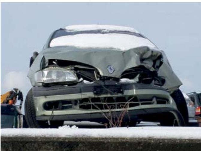
Auf dem Bild sichtbare Schadenpunkte: 35. Das Fahrzeug ist dennoch als Abfall zu klassieren, weil Fahrwerk und Chassis deutlich verzogen sind (nach aussen gerichtete Räder).
